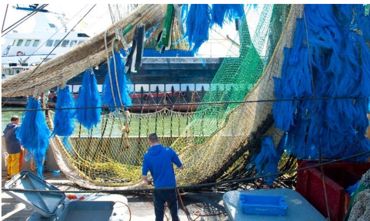
Figuur 2.1 Pluis bevestigd onder een visnet Foto: W.J. Strietman.
